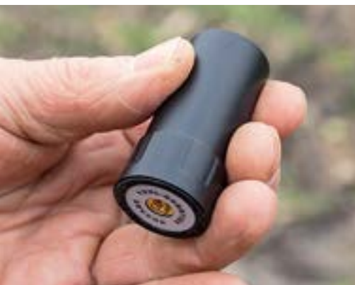
Die Satellitenantenne wird auf das Tablet geschraubt und versorgt den internen Zweifrequenz-GNSS-Empfänger mit Signalen.
