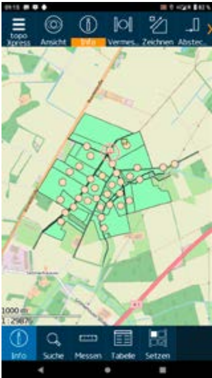
Der Kern des GEOmeter Tab ist das mobil-GIS topoXpress. Die Android-Standardtasten unten am Bildschirm sind Softkeys.
