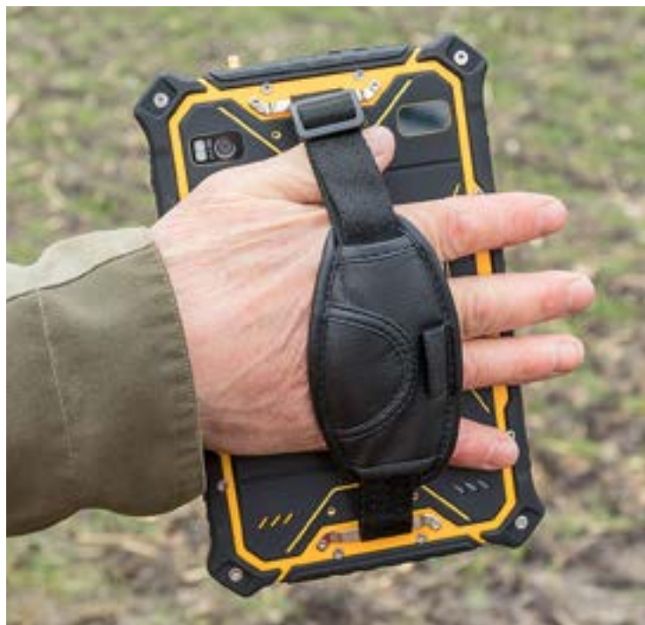
Ein hilfreiches Detail ist der Handgurt an der Rückseite des Gerätes. Fotos: Tovornik, Holtmann (1)
